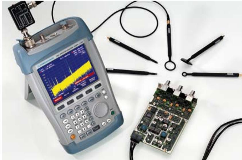
Sondensatz R&S®HZ-15 mit dem Spektrumanalysator R&S®FSH3 und dem Vorverstärker R&S®HZ-16
